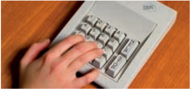
Spezielles 18-Tasten-KeyPad zur Steuerung der Produkte für Blinde
