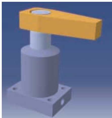
Der Raum, den die Bewegung des Spannelementes benötigt, steht als Volumenmodell für Kollisionsbetrachtungen zur Verfügung.
