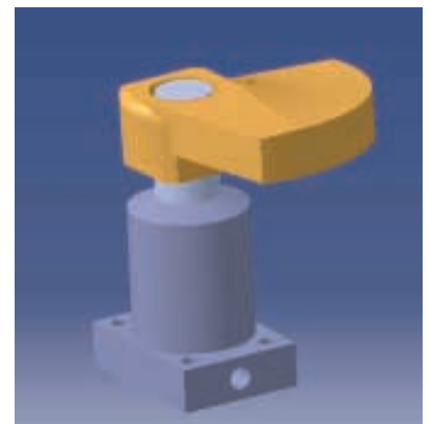
Der Raum, den die Bewegung des Spannelementes benötigt, steht als Volumenmodell für Kollisionsbetrachtungen zur Verfügung.
