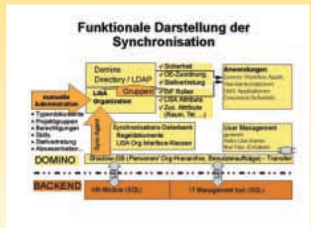
Bild 2: Technisches Schichtenmodell: Funktionale Darstellung der Synchronisation
