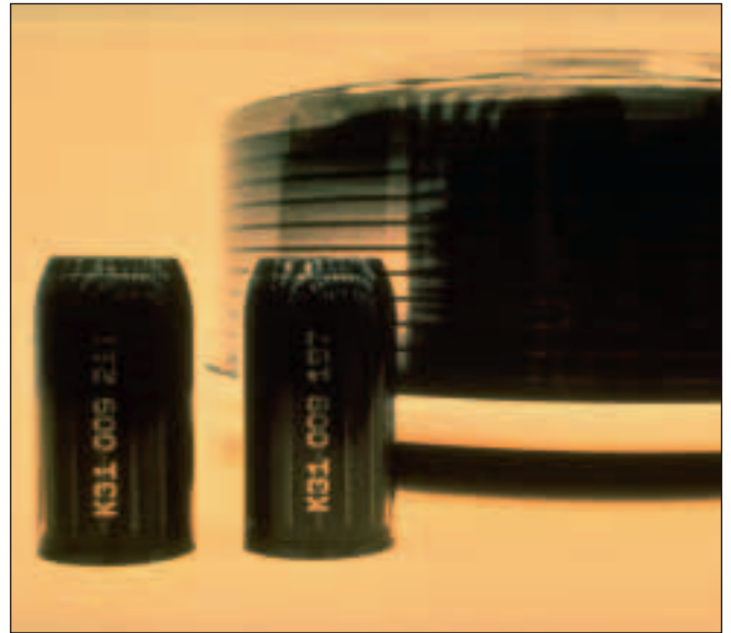
IBM 3850 Bandpatronen mit 19,5 Metern Bandlänge und einer Kapazität von jeweils 50 MB im Größenvergleich zum 3330 Plattenstapel mit 100 MB Kapazität
