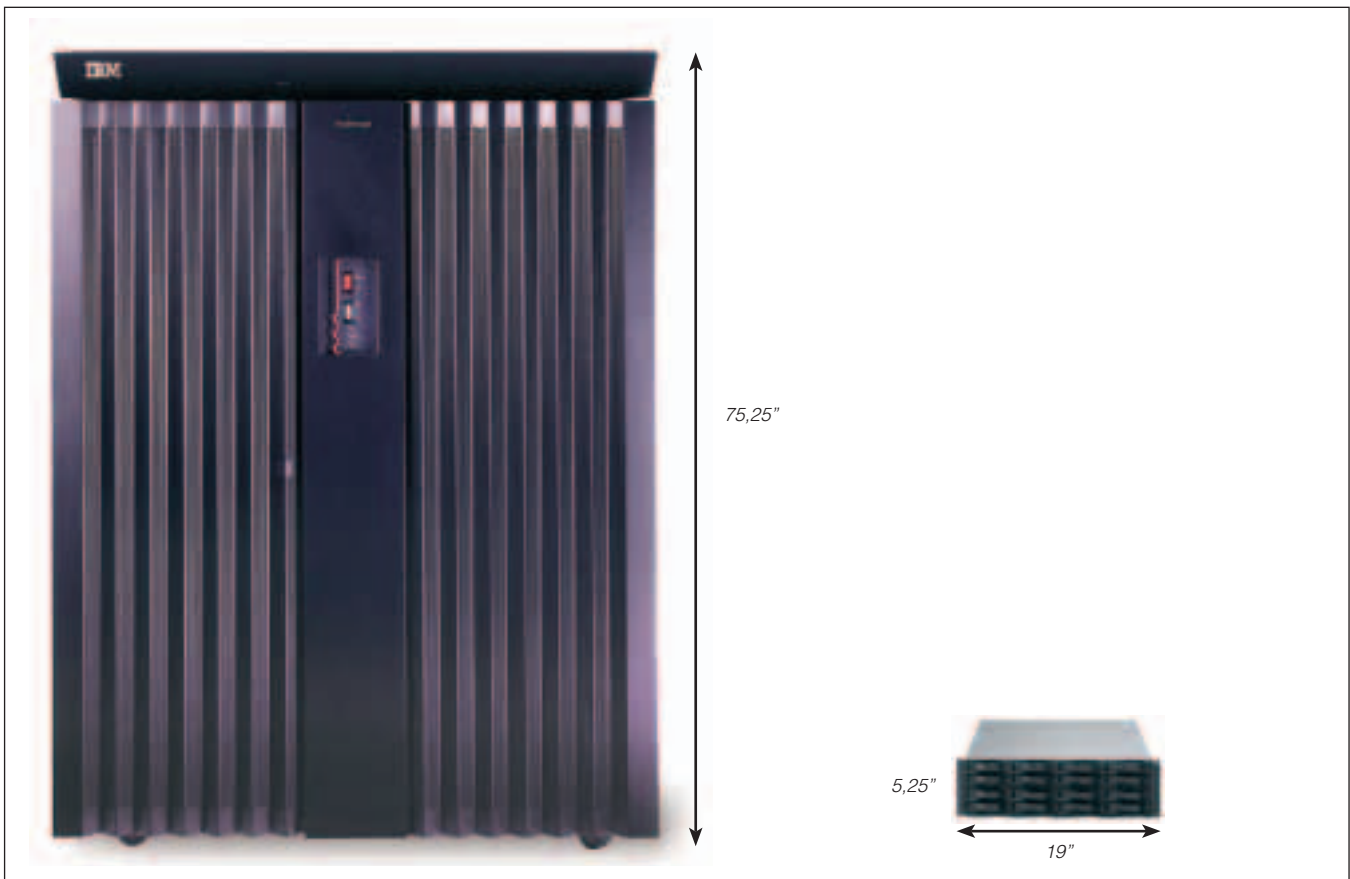
IBM ESS 750 mit 5 TB Kapazität
