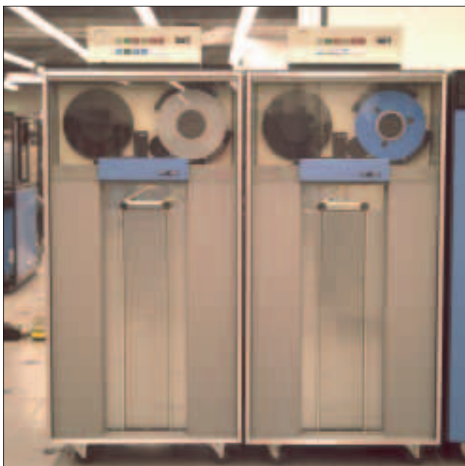
IBM 3420 Magnetbandeinheit, 1970 Modelle 3, 5 und 7, 1973 Modelle 4, 6 und 8
