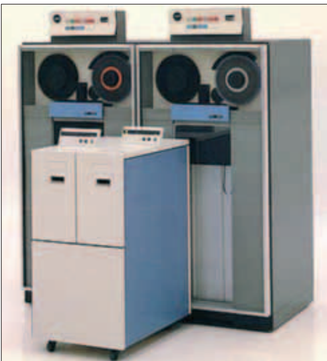
Größenvergleich Magnetbandsysteme IBM 3420 gegenüber IBM 3480
