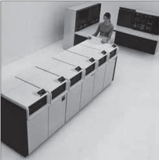
IBM 3350, Kapazität bis 2536 MB, 317 MB per LW, 8 Laufwerke pro 3350 Strang, Zugriffszeit 25 ms, Datenrate 1198 KB/s, links hinten: Display-Einheit für Micro-fiches, rechts hinten: Steuerkonsole des Systems/370 Modell 168
