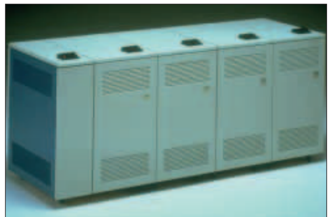
IBM 3370, 1 Plattenstapel pro Einheit mit 2 Zugriffsarmen und 2 Adressen, Modell 1: 571 MB, Modell 2: 730 MB, jeweils per Einheit, bis zu 4 Einheiten mit 2285 – 2920 MB Kapazität, Zugriff 20 ms, Datenrate 1.86 MB/s
