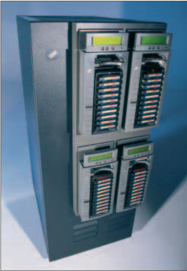
IBM 3590 Magstar Tape Subsystem 1995: IBM 3590-B mit 9 MB/S Datenrate 1999: IBM 3590-E mit 14 MB/S Datenrate 2002: IBM 3590-H mit 14 MB/S Datenrate Kassettenkapazitäten (native):
