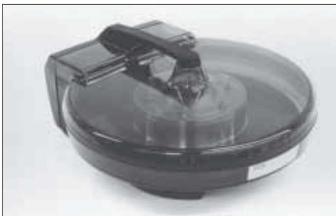
Aufbau IBM 3340 Winchester-Wechselplattenstapel
