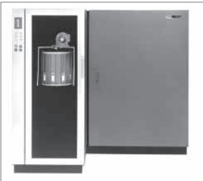
IBM 2321, Gesamtkapazität von 400 MB, Ausbaustufen von 40 bzw. 80 MB, Zugriffszeiten von 95 bis 600 ms
