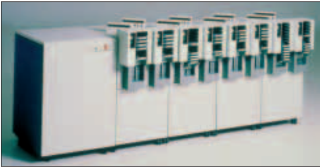
1984: Wechsel vom klassischen Rollenband auf die 3480 Kassettentechnologie
