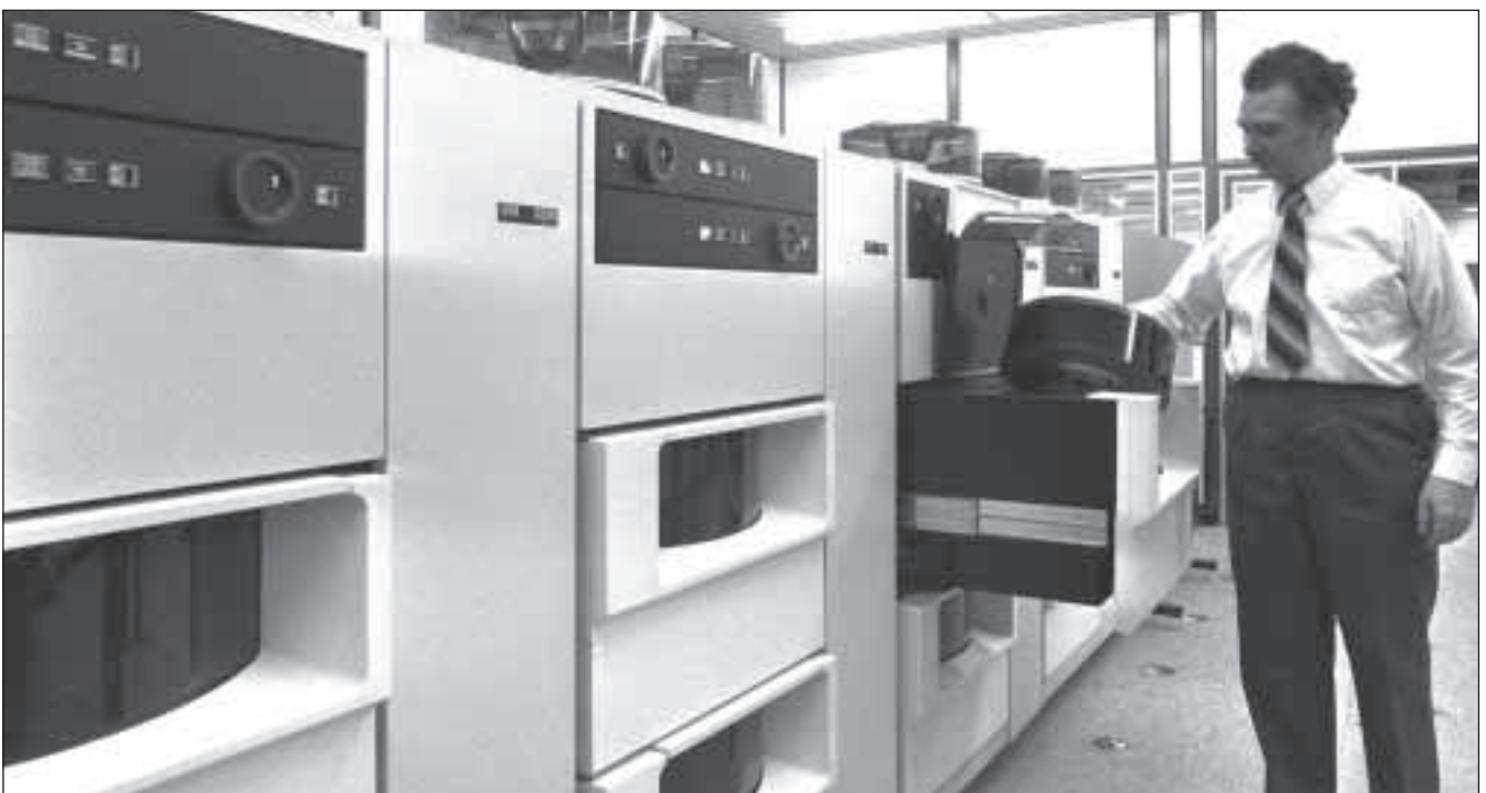
IBM 3330, Kapazität 800 MB, 2–8 Laufwerke, Zugriffszeit 30 ms, Datenrate 806 KB/s, Ankündigung Modell 1 am 30. Juni 1970, Modell 2 am 4. Oktober 1972, Modell 11 am 17. Juli 1973, Zurückziehung vom Vertrieb am 20. Dezember 1983
