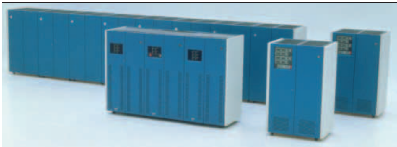
1989: IBM 3390-1/2, 1991: IBM 3390-3, 1994: IBM 3390-9, hinten IBM 3380-K Strang mit 60 GB Kapazität, vorne 3390-3 Strang mit 90 GB Kapazität, rechts IBM 3390 Steuereinheiten
