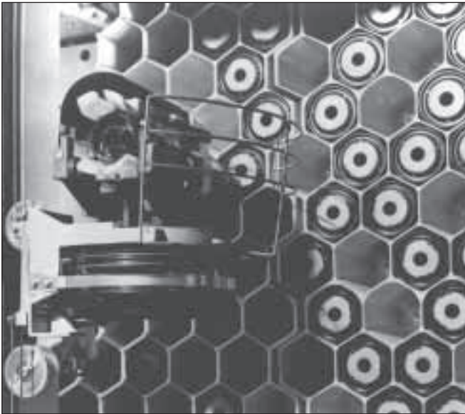
IBM 3850 Roboter mit Doppelgreifer (Standard) in Aktion
