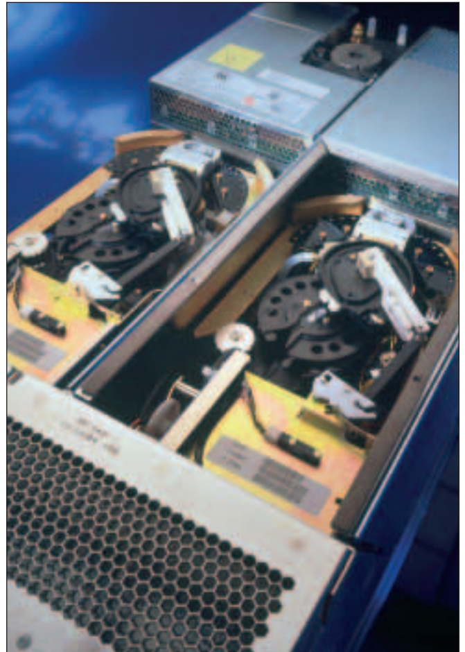
Blick in die IBM 3590 Magstar Laufwerke
