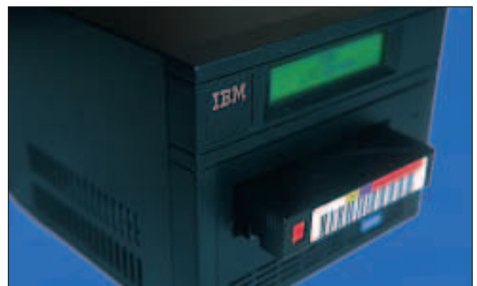
Kassettenladevorgang beim IBM LTO 1 Laufwerk
