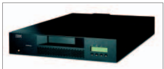
IBM 3582 Mini-Library mit bis zu 23 LTO-Kassetten. ADIC Vertrieb unter ADIC Logo das Produkt als Scalar 24
