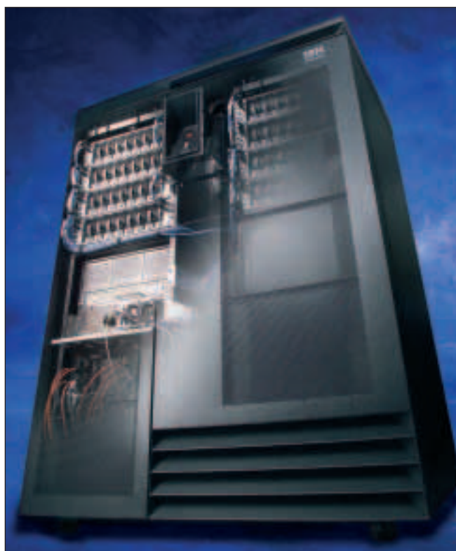
Enterprise Storage Server ESS (Shark), 1999: Modelle E10/E20 bis 11 TB, 2001: Modelle F10/F20 bis 35 TB, 2002: Modelle 800 und 800 Turbo II bis 56 TB, April 2004: Entry-Modell 750 bis 5 TB (Brutto-Kapazitäten)
