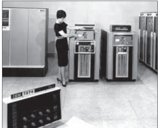
IBM 7340 Hypertape Drives in der Bildmitte, links die IBM 7640 Kontrolleinheit, rechts die IBM 729 Bandeinheiten
