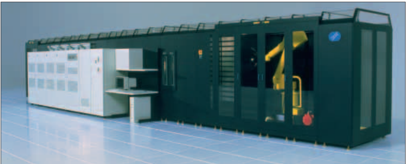
IBM 3495 Bandarchiv mit 5660 bis 18920 Kassetten (13.5 bis 45.5 Terabyte), Höhe 2.38 Meter, Tiefe 2.46 Meter, Länge modellabhängig 13.4, 18.3, 23.2 oder 28.0 Meter, 4 bis maximal 64 Laufwerke IBM 3490
