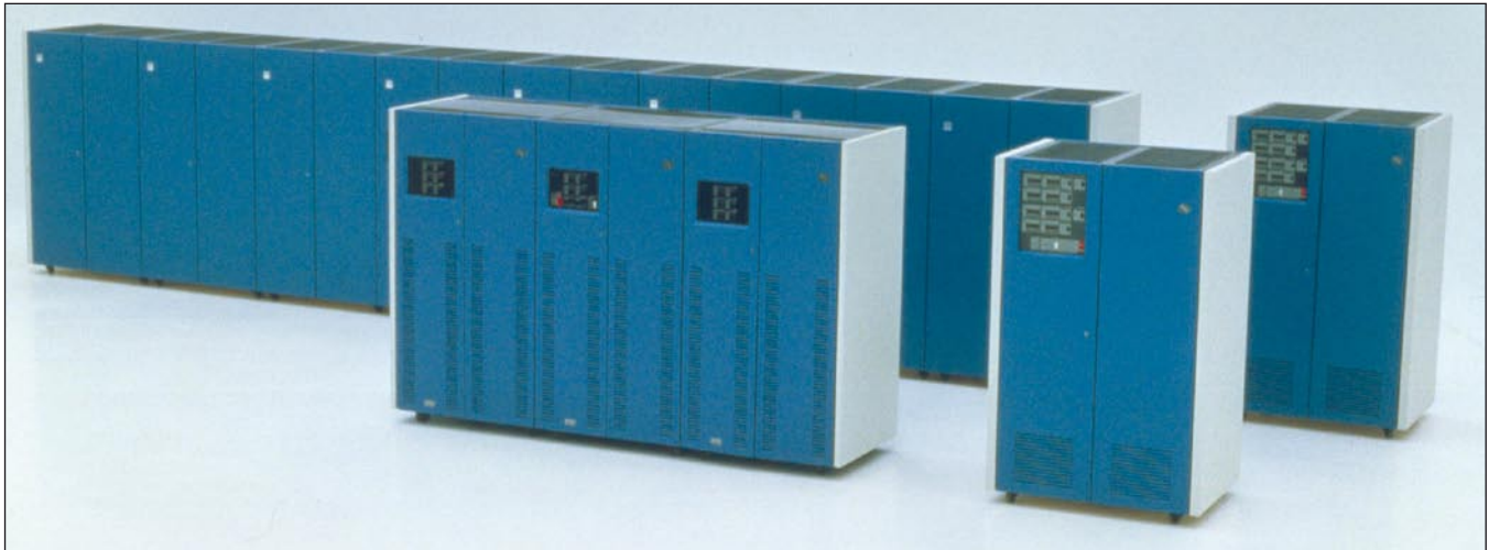
1989: IBM 3390-1/2, 1991: IBM 3390-3, 1994: IBM 3390-9, hinten IBM 3380-K Strang mit 60 GB Kapazität, vorne 3390-3 Strang mit 90 GB Kapazität, rechts IBM 3990 Steuereinheiten
