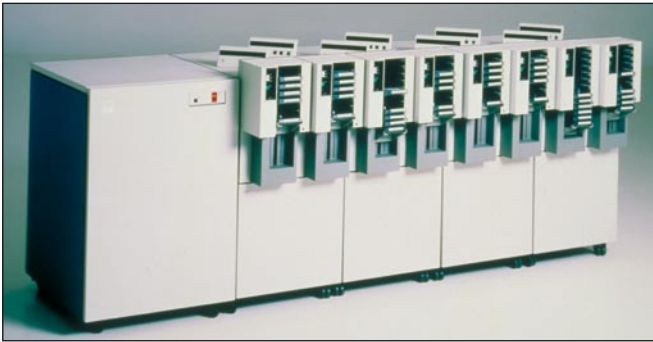
1984: Wechsel vom klassischen Rollenband auf die 3480 Kassettentechnologie
