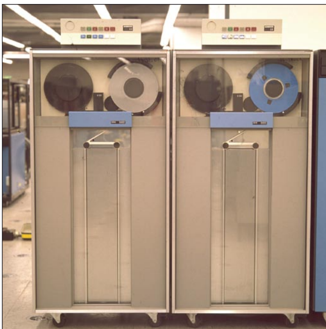
IBM 3420 Magnetbandeinheit, 1970 Modelle 3, 5 und 7, 1973 Modelle 4, 6 und 8
