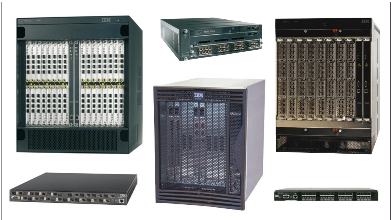
1999–2006: IBM SAN, Switches und Direktoren der Hersteller Brocade, McData (CNT) und Cisco
