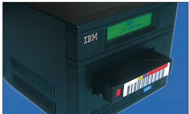
Kassettenladevorgang beim IBM LTO1 Laufwerk
