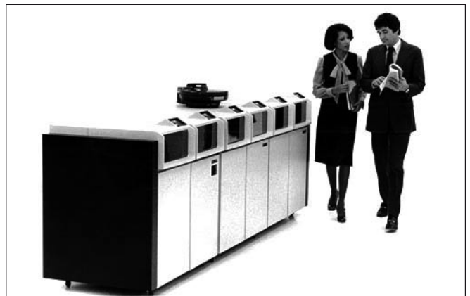
IBM 3340, Maximalkapazität bis 4800 MB, Winchester-Wechselplatten Modell 35: 35 MB, Modell 70: 70 MB, bis zu 64 Laufwerke (Modelle 158, 168), Datenrate 885 KB/Sekunde, Zugriffszeit 25 ms
