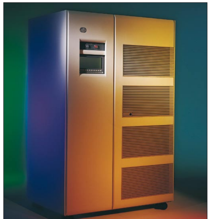
1996 – 1998 IBM RAMAC Virtual Array RVA, IBM RAMAC Virtual Array 1996, IBM RAMAC Virtual Array Turbo 1997, IBM RAMAC Virtual Array Turbo 2 1998, Kapazitäten von 840 GB bis 1680 GB Arrays 13+2+1 RAID6 oder 2 x (5+2+1), Array Kapazität bis 420 GB, Minimalkonfiguration: 2 Arrays, Maximalkonfiguration: 4 Arrays
