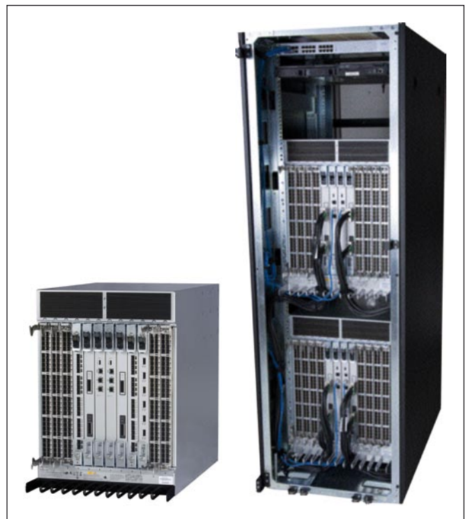
IBM Direktor SAN768B (Brocade DCX) mit bis zu 896 Ports
