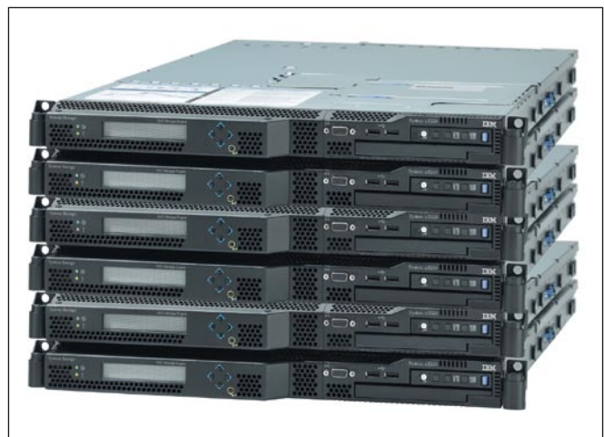
SAN Volume Controller SVC: 3 Knoten im Cluster
