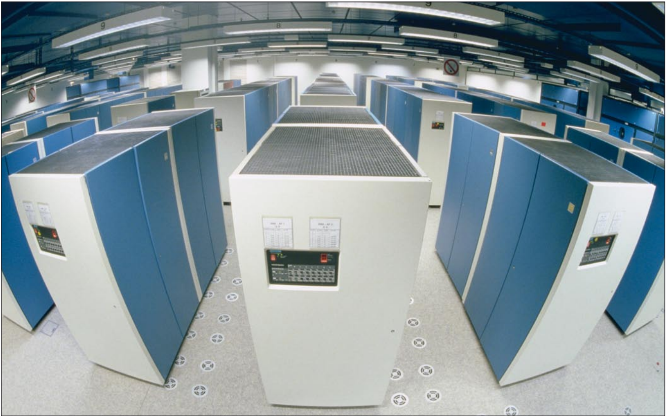
IBM 3380 Platten und 3880 Steuereinheiten füllten damals ganze Rechenzentrumshallen
