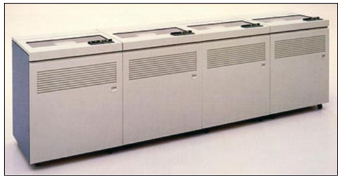
IBM 3430 Magnetbandsystem, letztes Rollenband der IBM, Markteinführung 1983
