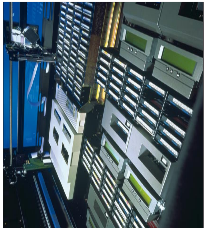
IBM 3494 Gehäuseeinheit D22 mit 'Cradles' und TS1120(Jaguar)-Laufwerken
