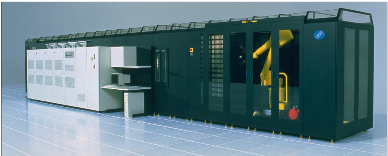
IBM 3495 Bandarchiv mit 5660 bis 18920 Kassetten (13.5 bis 45.5 TB), Höhe 2.38 Meter, Tiefe 2.46 Meter, Länge modellabhängig 13.4, 18.3, 23.2 oder 28.0 Meter, 4 bis maximal 64 Laufwerke IBM 3490
