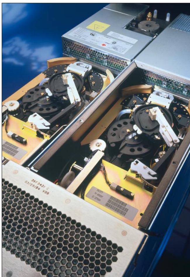
Blick in die IBM 3590 Magstar Laufwerke
