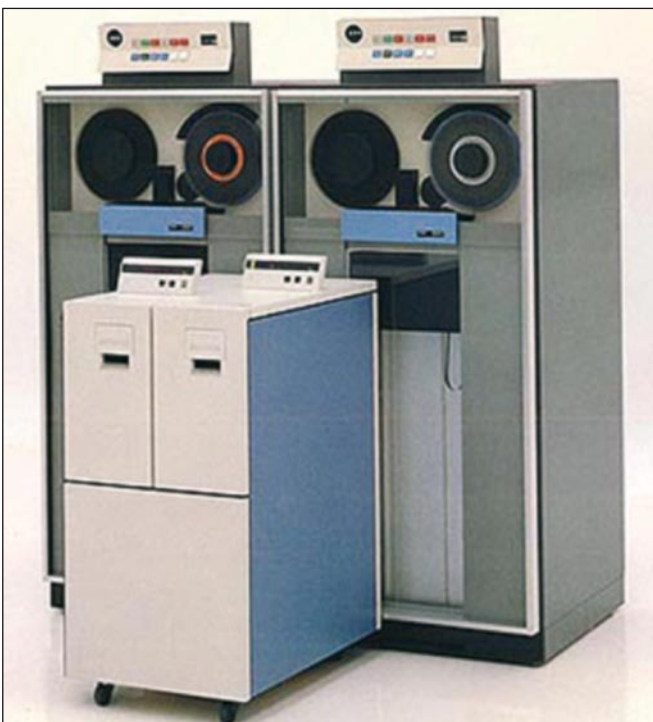
Größenvergleich Magnetbandsysteme IBM 3420 gegenüber IBM 3480
