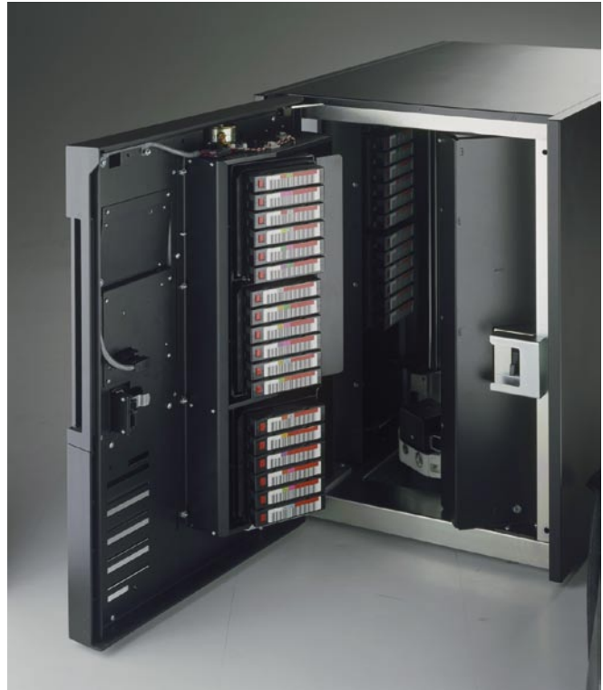
IBM 3583 Ultrium Scalable Tape Library mit geöffneter Tür
