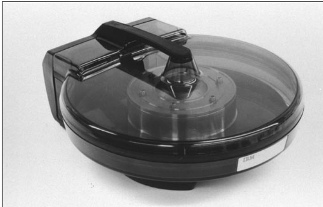
Aufbau IBM 3340 Winchester-Wechsellplattenstapel
