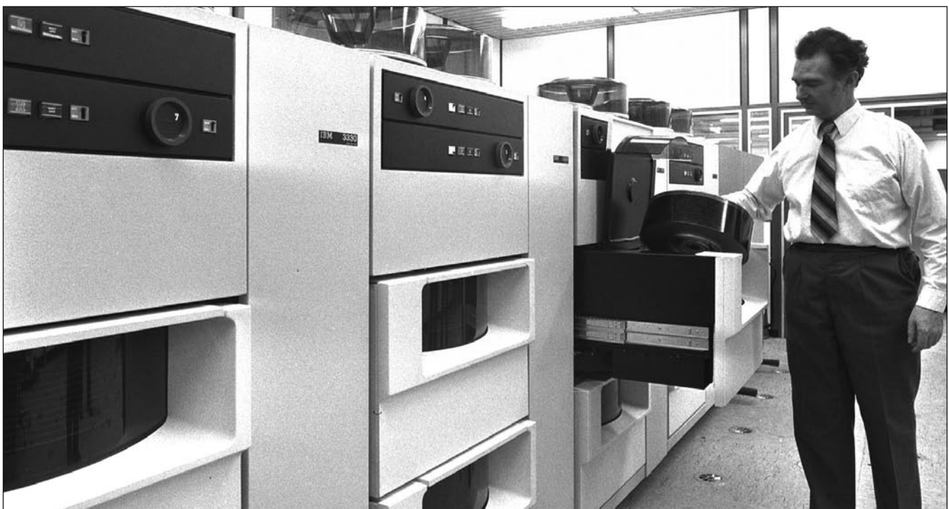
IBM 3330, Kapazität 800 MB, 2–8 Laufwerke, Zugriffszeit 30 ms, Datenrate 806 KB/s, Ankündigung Modell 1 am 30. Juni 1970, Modell 2 am 4. Oktober 1972, Modell 11 am 17. Juli 1973, Zurückziehung vom Vertrieb am 20. Dezember 1983
