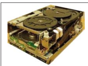
IBM TS1040 LTO4-Laufwerk ohne Gehäuse
