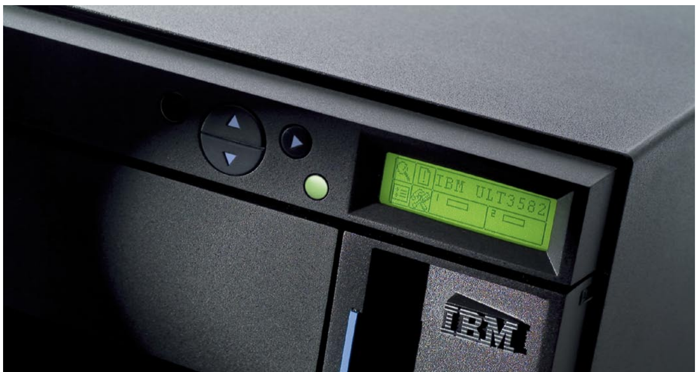
IBM 3582 Display – Mini-Library mit bis zu 23 LTO-Kassetten
